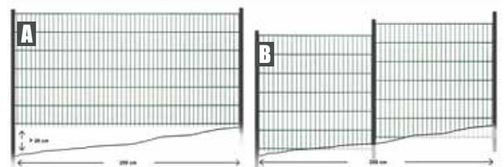
**Beispiel A:** Bei einem Zaunverlauf mit bis zu 20 cm Höhendifferenz pro Element wird an der Stelle, wo das Element den Boden berührt, eine Furche gezogen und dort eingelassen.
