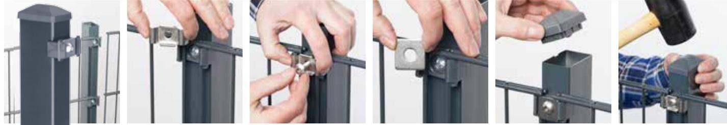
Nach dem Einhängen der Zaunelemente und der Überprüfung des richtigen Sitzes an allen Befestigungspunkten werden die V2A-Sicherheitsklemmen mit der beiliegenden Schraube verschraubt.
