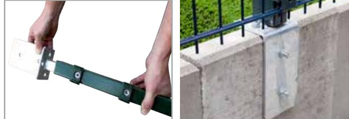
Zaunpfosten mit den Fußplatten-Adaptoren verbinden, dann beides auf dem Fundament oder L-Steinen positionieren. Löcher nach Herstellerangaben bohren und Bolzenanker einschlagen, Muttern gleichmäßig anziehen - mit Wasserwaage ausrichten und festziehen.
