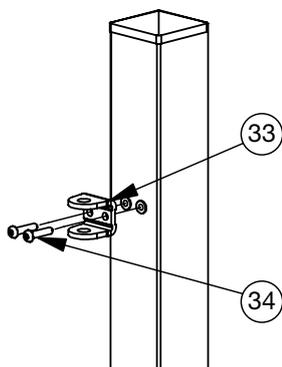
Die U-Anschraubplatte (33) mit Hilfe der Zaunbauschrauben (34) anbringen.
