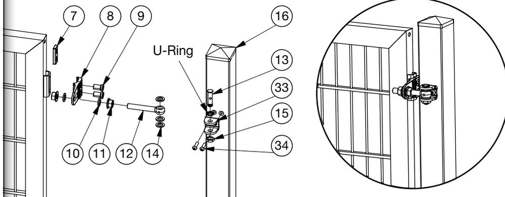
Die Scharnierlasche (8) mit Hilfe der Scharniergegenplatte (7) und der Scharnierlaschenschrauben (9) am Torflügel (1) befestigen. Die Augenschraube (12) mit Hilfe der Unterlegscheibe (14), dem Bolzen (13) und der Sechskantmutter (15) an der bereits angeschraubten U-Anschraubplatte (33) am Scharnierpfosten (2) befestigen.
