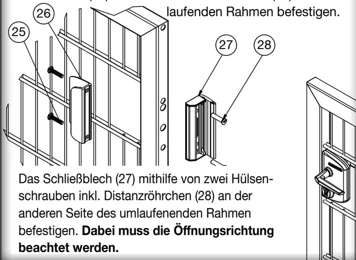
Das Schließblech (27) mithilfe von zwei Hülsen-schrauben inkl. Distanzröhrchen (28) an der anderen Seite des umlaufenden Rahmen befestigen. **Dabei muss die Öffnungsrichtung beachtet werden.**
